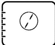
Horký vzduch zahříváný prvky s ventilátorem se rovnoměrně rozvádí po celé troubě velmi rychle pomocí ventilátoru. Hodí se na ohřívání vašich pokrmů na různých úrovních polic, ve většině případů není nutné troubu předehřívat. Vhodné pro použití více plechů.
