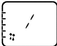
Trouba se nezahřívá. Funguje pouze ventilátor (v zadní stěně). Zmražené potraviny se rozmrazuje pomalu při pokojové teplotě, upečené potraviny se ochladí.
