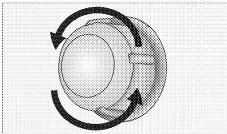
3. Ak je vaše svetlo v rúre typu (A), ktorý je vyobrazený nižšie, vyberte svetlo otočením (pozrite si obrázok) a vymeňte ho. Ak je svetlo typu (B), zatiahnite a vyberte svetlo (pozrite si obrázok) a vymeňte ho.
