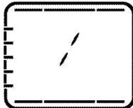
Horúci vzduch ohriaty dolnými a hornými ohrevnými prvkami sa pomocou ventilátora veľmi rýchlo rovnomerne rozšíri po celej rúre. Varte na jednom plechu.
