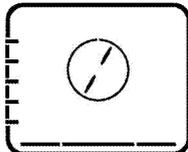
Töötavad alumine kuumutus ja ventilaatorkuumutus. Sobib pitsa küpsetamiseks.
