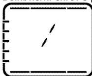
Horký vzduch zahříváný horními a dolními prvky se rovnoměrně rozvádí po celé troubě velmi rychle pomocí ventilátoru. Používejte vždy jeden plech.
