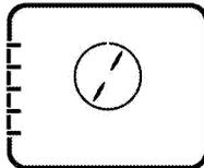
Seda funktsiooni saate kasutada energia säästmiseks ventilaatorkuumutuse asemel 160–220 °C temperatuurivahemikus. Küpsetusaeg pikeneb mõnevõrra. Selle funktsiooniga seotud küpsetusajad on kirjas tabelis "**Ökonoomne ventilaatorsoojendus**".
