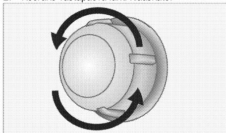
3. Kui teie ahjutuli on alloleval joonisel kujutatud (A) tüüpi, eemaldage see joonisel näidatud viisil keerates ja asendage uuega. Kui teie ahjutuli on (B) tüüpi, eemaldage see joonisel näidatud viisil tõmmates ja asendage uuega.
