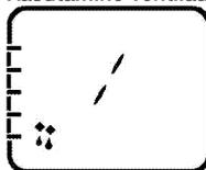
Ahju ei kuumutata. Töötab ainult ventilaator (tagaseinas). Sobib külmutatud peenestatud toidu aeglaseks sulatamiseks toatemperatuurini ja küpsetatud toidu jahutamiseks.
