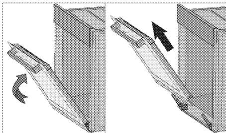
4. Demontujte přední dvířka tak, že je zatlačíte nahoru, pokud je chcete uvolnit z pravého a levého závěsu.
