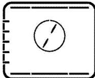
Töötavad ülemine kuumutus, alumine kuumutus ja ventilaatorkuumutus. Toit pruunistub ning küpseb ühtlaselt ja kiiresti läbi. Kasutage küpsetamiseks korraga ainult ühte panni.
