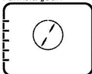
Horúci vzduch ohriaty ohrevným prvkom s asistenciou ventilátora sa pomocou ventilátora veľmi rýchlo rovnomerne rozšíri po celej rúre. Je vhodné pre varenie vašich jedál v rôznych úrovniach podstavcov a vo väčšine prípadov nie je potrebné predhrievanie. Vhodné na varenie s viacerými plechmi.
