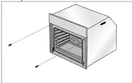
Kinnitage ahi joonisel näidatud viisil kahe kruviga. Pärast paigaldamist veenduge, et kruvid on kõvasti kinni ja ahi ei liigu. Kui ahi pole paigaldatud juhiste järgi või kruvid pole piisavalt tugevasti kinni, võib ahi kasutamise ajal ümber kukkuda.
