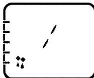
Rúra sa neheje. V prevádzke je len ventilátor (v zadnej stene). Mrazené granulované jedlo sa roztápa pomaly pri izbovej teplote a varené jedlo sa ochladzuje.
