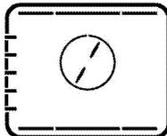
Horní ohřev, dolní ohřev a ohřev s ventilátorem jsou zapnuté. Pokrm je rovnoměrně a rychle upečen ze všech stran. Používejte vždy jen jeden plech.
