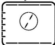
V prevádzke je horné ohrevanie, dolné ohrevanie a ohrevania s asistenciou ventilátora. Jedlo sa rovnomerne a rýchlo varí z každej strany. Varte len s jedným plechom.
