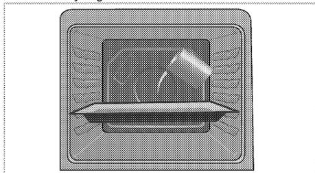
3. Nastavte troubu do režimu snadné čištění parou a běh na 100 ° C po dobu 25 minut.
